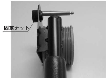
1. 固定ナットを押さえながら、ノブを回してシャフトから外します。
