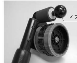
1. ノブを時計回りに回して、ゴム印にインクロールを押し当てます。
