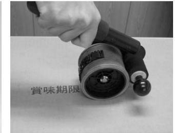
3. 本体を前に押し出して印字テストをします。この時インクがかずれる場合は、ゴム印とインクロールの接触が不十分ですので、ノブを回して調整してください。
