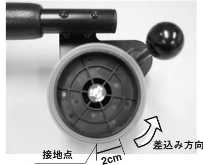
1. 接地点より約2cm右横からゴム印をクッションシートに差込みます。
