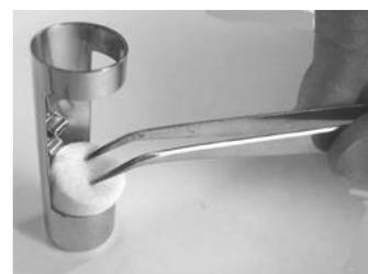
④古いフェルトをピンセットで取り外します。⑤新しいフェルトをセットします。
